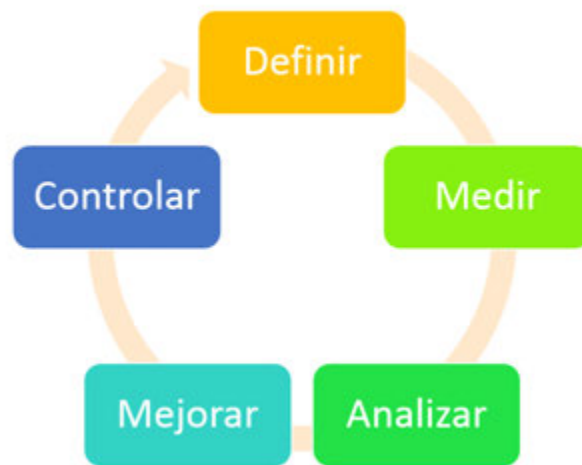
Fig. 10.2. Esquema DMAIC para el método Seis Sigma [111].
