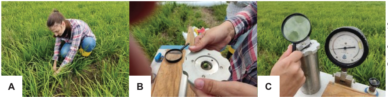
Figura 1. Processo de avaliação da tensão de água no xilema das plantas de arroz. Coleta da amostra (perfilho principal da planta) na lavoura de arroz (A); inserção da planta de arroz na estrutura de fixação da câmara de Scholander (B); e avaliação da pressão necessária para contrapor a tensão da água no xilema da planta de arroz (C).
