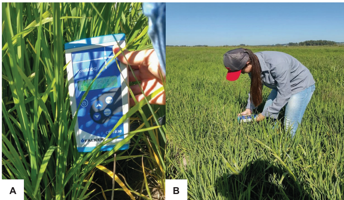
Figura 2. Processo de aferição da clorofila em plantas de arroz. Equipamento Clorofilog Falcker (A), e sua utilização na lavoura de arroz cultivado sobre sulco-camalhão (B).
