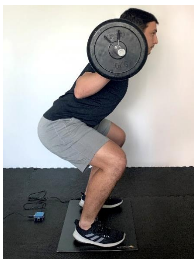
Figura 3 - Setup experimental para a determinação do perfil de força-velocidade dos membros inferiores. A imagem realça a posição inicial do SJ com salto, com carga adicional
