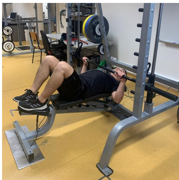
Figura 4 - Setup experimental para a determinação do perfil de força-velocidade dos membros superiores. A imagem mostra a posição inicial do movimento, realçando a braçadeira de nylon utilizada para medir a altura de lançamento
