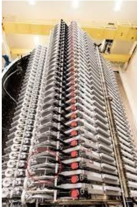
Рис. 3.2 Укомплектування супутників для запуску на орбіту
