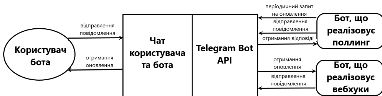
Рис. 2.3. Схематичне зображення функції Telegram Bot API
