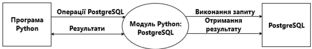
Рис. 2.14. Схема взаємодії програми Python з базою даних PostgreSQL через посередництво модуля psycopg2
