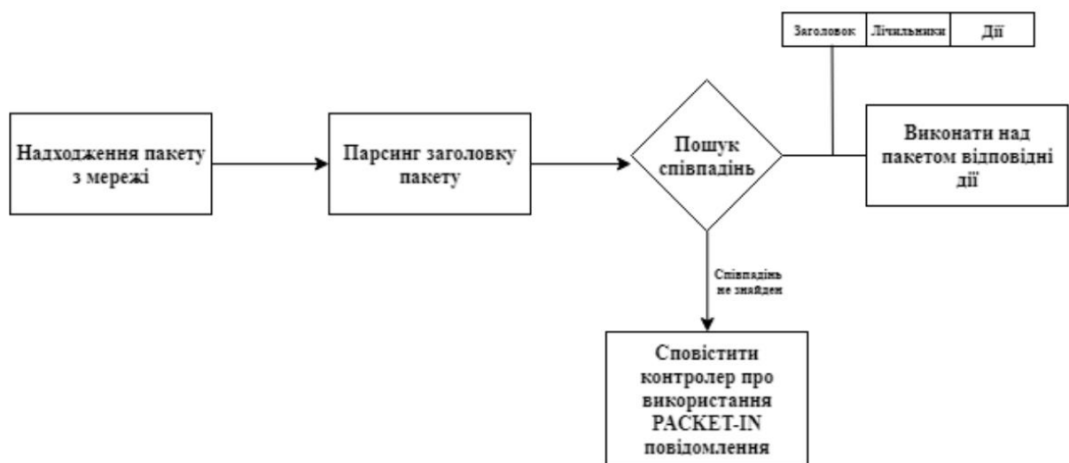
Рис. 2.5. Схема проходження пакету через комутатор OpenFlow
