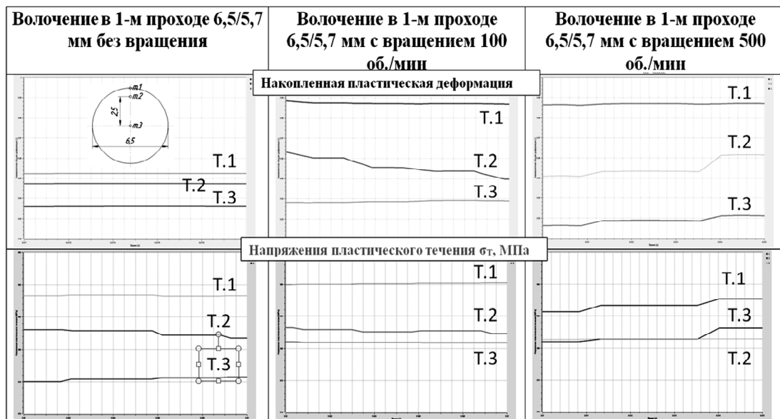
Рис. 1. Динамика изменения напряжений пластической деформации по длине очага в контрольных точках
