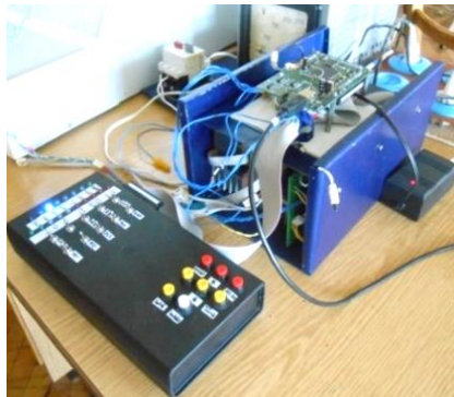
Рис. 5.3. Силовий перетворювач на основі модуля PM50CLA120
