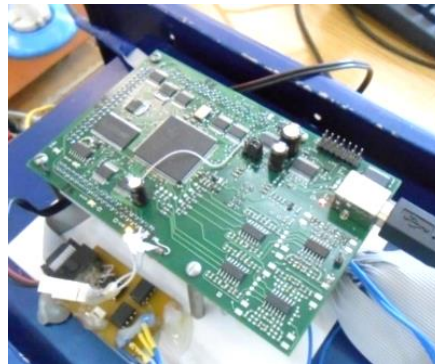
Рис. 5.3. Силовий перетворювач на основі модуля PM50CLA120
