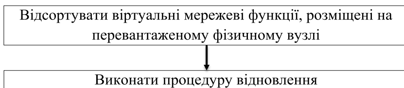
Рис. 5.5 Схема відновлення вузла з перевантаженням
