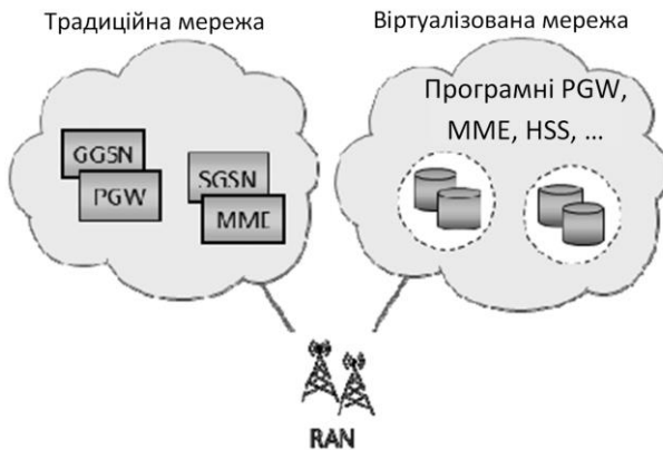
Рис. 1.21 Часткова віртуалізація базової мобільної мережі
