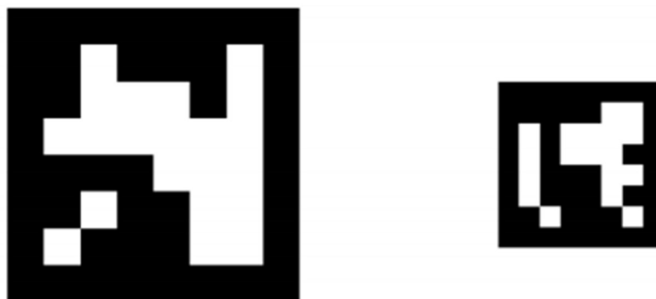
Рисунок 2.5 - Приклади ARUCO-маркерів різних розмірів
