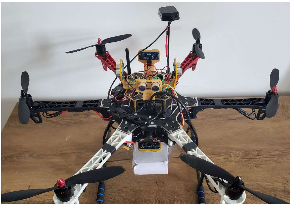
Рисунок 3.1 - Фото зібраної апаратної платформи вантажного БПЛА
