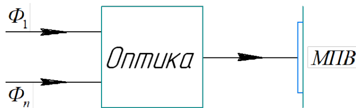
Рис. 1.11. Формування сигналу з почерговим вибором вхідного потоку
