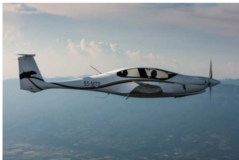
Slika 3.1: Prvo 4-sedežno letalo na hibridni pogon Panthera S5-MTP podjetja Pipistrel (Pipistrel, 2022).
