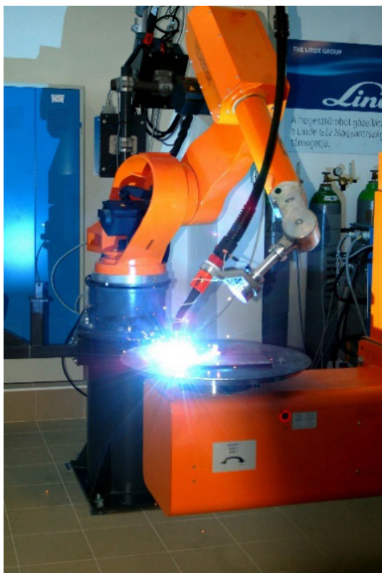
3. ábra. Hegesztő robotcella a Bánki Karon
