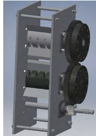
1. ábra. Ágaprító gép elemeinek összeszerelési vázlata
