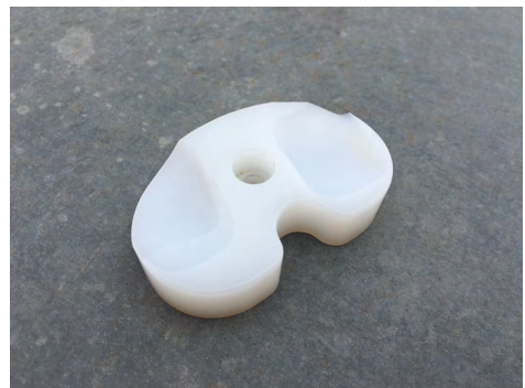
6. ábra. CNC marással előállított lábszárcsonti térdprotézis komponens
