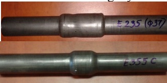
7. ábra. Robbantással készült csődarabok
