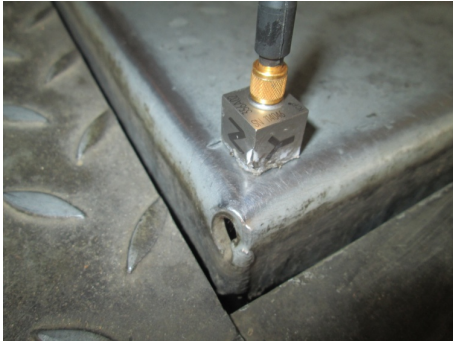
2. ábra: A gerjesztő berendezés mérése
