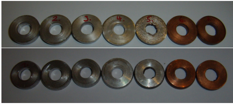
5. ábra. A zömített darabok felül- és alulnézete
