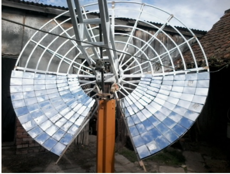
2. ábra. A tükör függőleges mozgást biztosító szerelése
