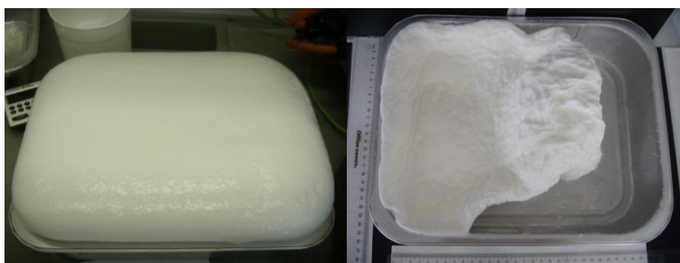
Abbildung 28: TDI-Schaum nach der Rezeptur für HDI-basierte Schäume aus Tabelle 2. Links: ursprüngliche Schaumhöhe direkt nach der Reaktion; rechts: nach Abkühlen und Volumenschwund.
