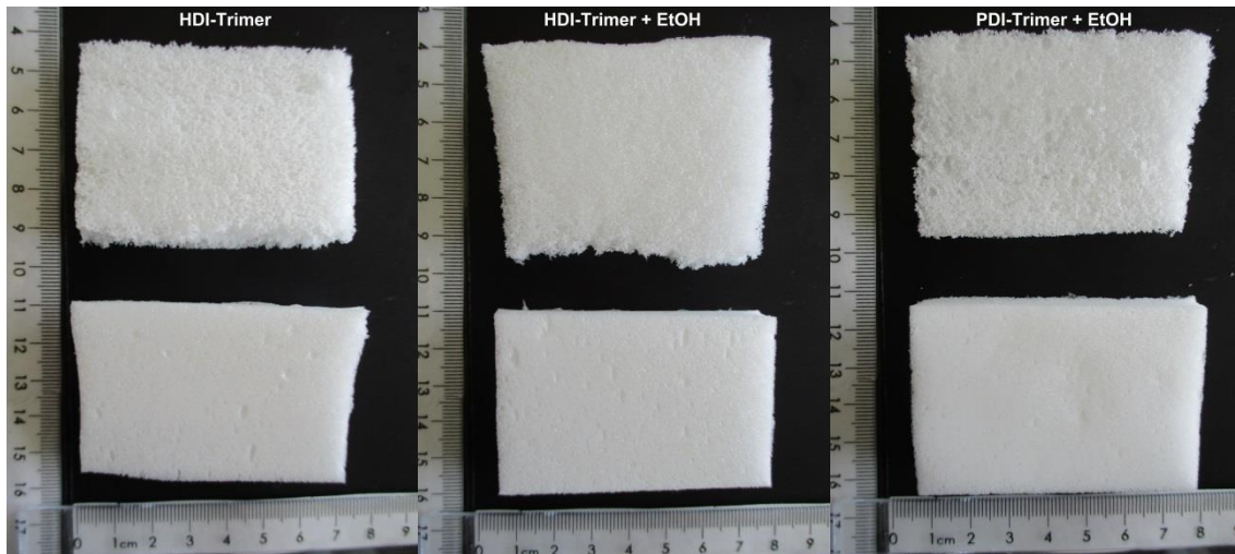
Abbildung 62: Optischer Vergleich von Proben aus konventionell hergestellten Schäumen (jeweils oben) und mit Vorreaktion hergestellten Schäumen (jeweils unten) für drei unterschiedliche Schaumrezepturen.
