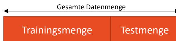
Abbildung 4.8: Schematische Darstellung des Prinzips der Aufteilung der gesamten Datenmenge in Trainings- und Testdaten
