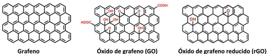
**Fig. 11.** Representación esquemática del grafeno y sus derivados oxigenados y reducidos.
