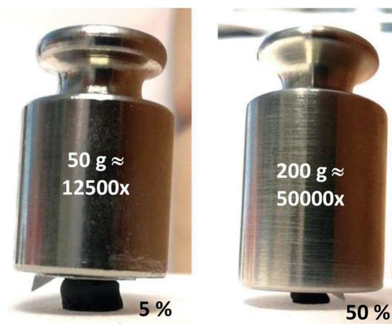
**Figura 22.** Experimento de medida de deformación de monolitos de aerogel de GO.
