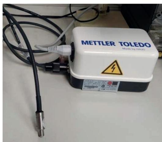
**Figura 16.** Desionizador utilizado para eliminar la carga estática de las muestras y recipientes antes de pesarlas.
