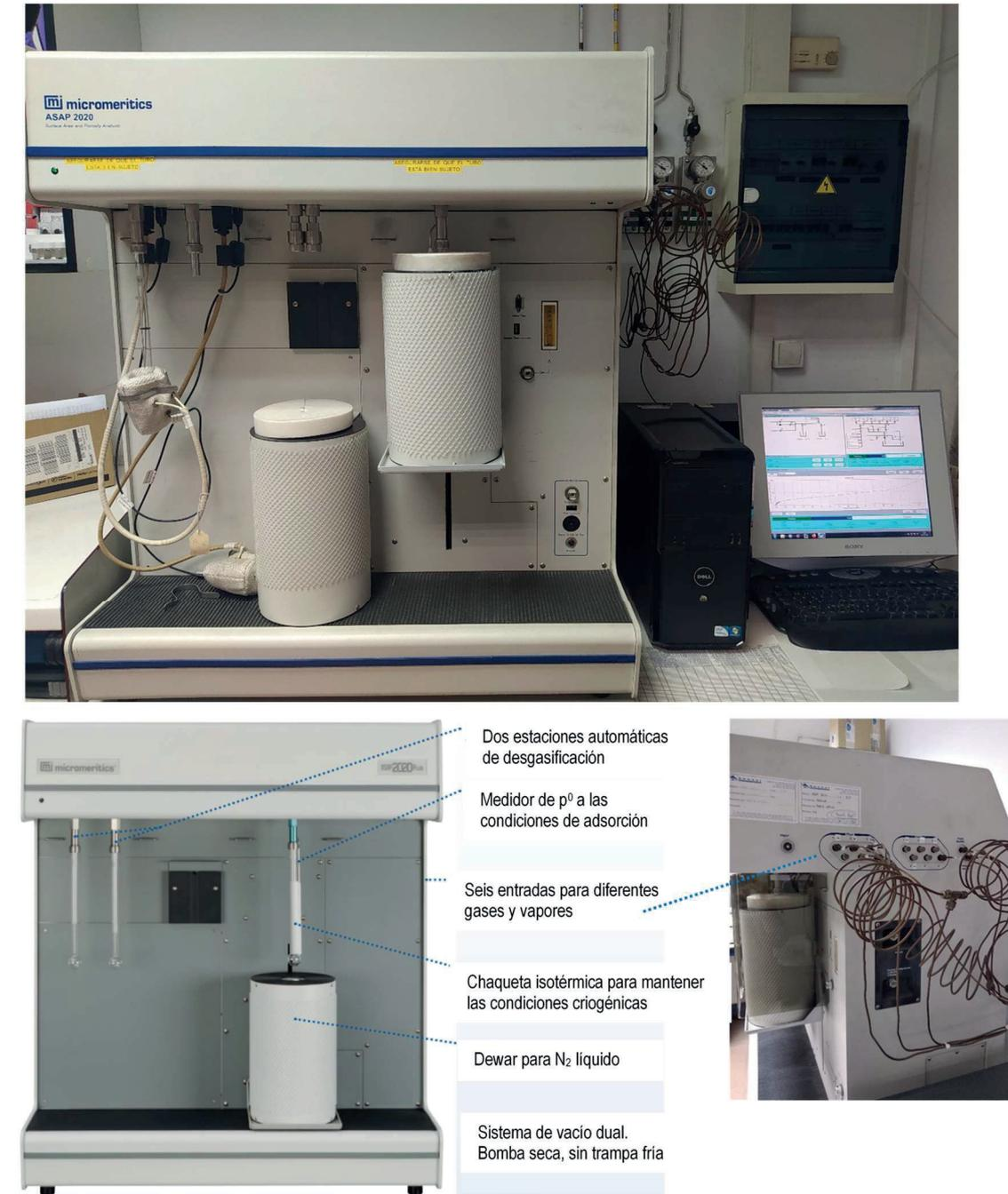
Figura 12. Vistas frontal y lateral del equipo ASAP 2020.
