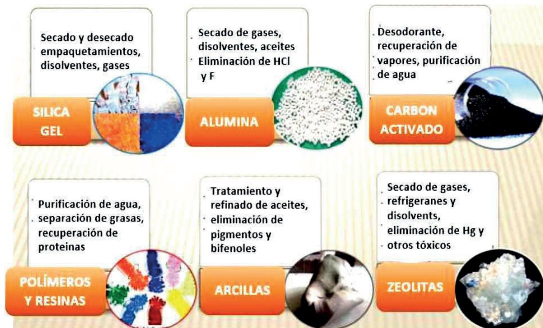
**Figura 1.** Adsorbentes comúnmente utilizados en la industria.
