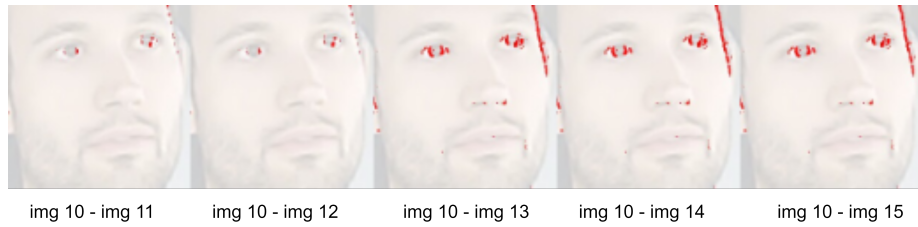
FIGURE 4.2 – Différences observées entre deux images successives du flux vidéo.
