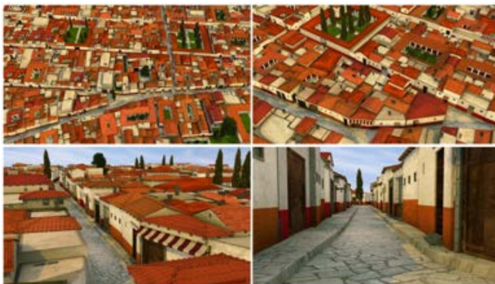
Figure 2.8 – Différentes vues du modèle de Pompéi. Basée sur de véritables empreintes de bâtiments, la ville a été générée avec 190 règles de forme CGA écrites manuellement. Source : Müller et al. [32]
