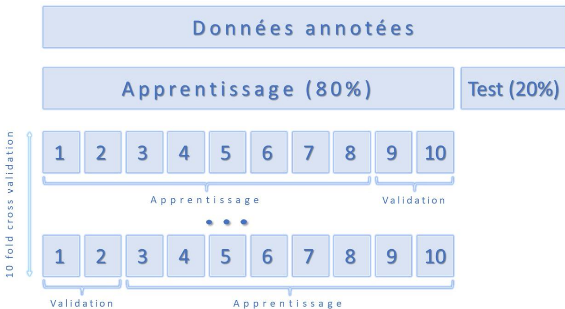
Figure 8 : Décomposition du set de données annotée en des sets d'apprentissage, de validation et de test avec la méthode de cross validation.
