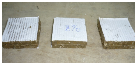
11.a. ábra. 8%-os polietilén-talaj keverék mintája és nyírási felülete
