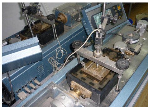
1. ábra. Közvetlen nyírási kísérlet vízzel telített mintával.
