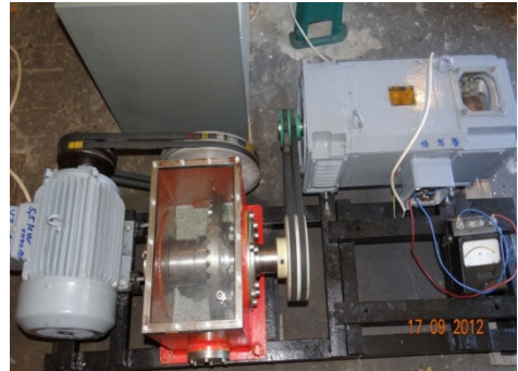
5. ábra. Új geometriájú kúpos csiga határfok mérés és zaj- és rezgésdiagnosztikai vizsgálata (DifiCAD Kft., Miskolc)
