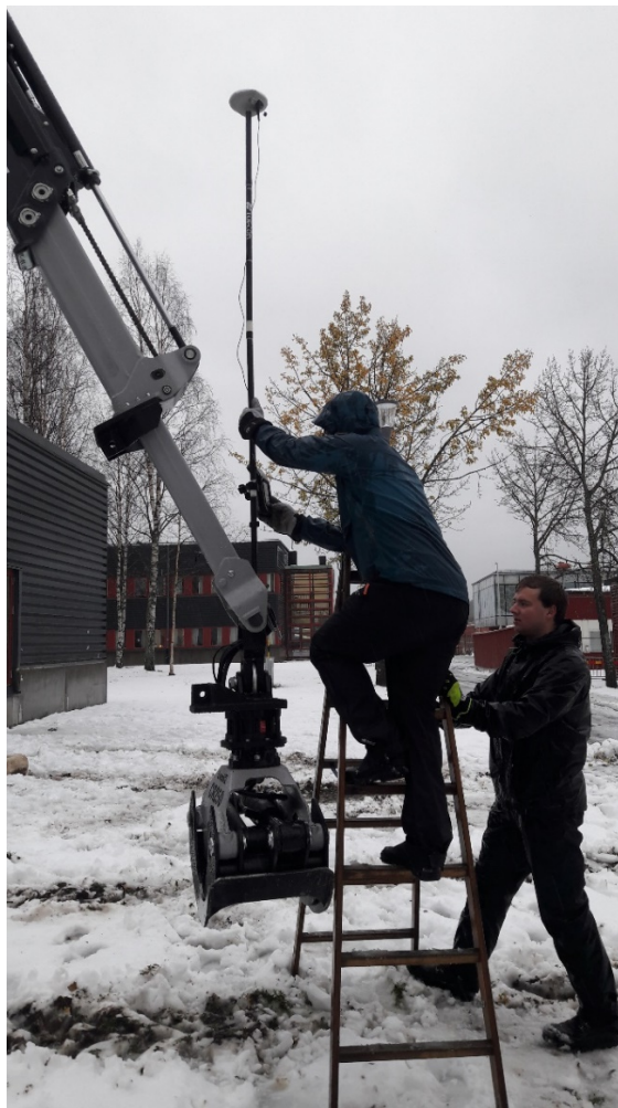
Figur 2. Datainsamling av kranspetsens verkliga position med mätutrustning.
