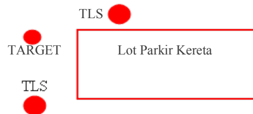
RAJAH 4. Sistem pengukuran Leica StanStation C10
