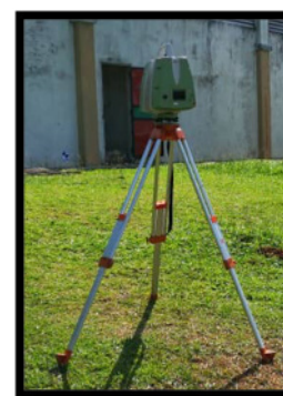
RAJAH 5. Alat Leica Scanner C10 didirikan di atas tripod
