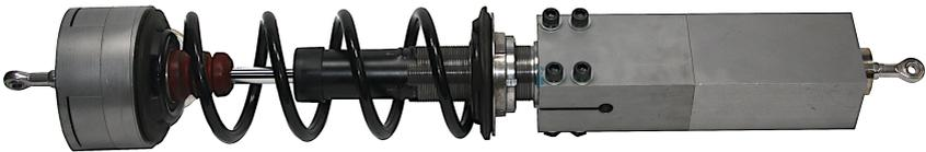
Abbildung 4.4: Feder-Dämpfer-System bestehend aus dem Federbein und den Anbindungen an das obere Tragwerk und untere Tragwerk
