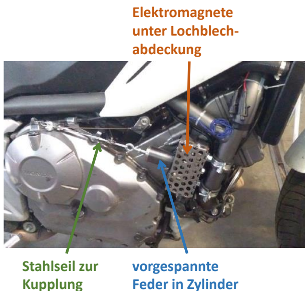
Abbildung A-3: Kupplungsaktor im eingebauten Zustand
