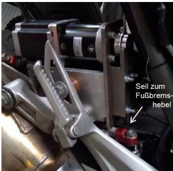
Abbildung A-1: An der Soziusfußraste montierter Bremsaktor
