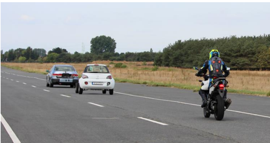
Abbildung 4-18: Motorradfahrer in Folgefahrt hinter EVITA mit Zugfahrzeug
