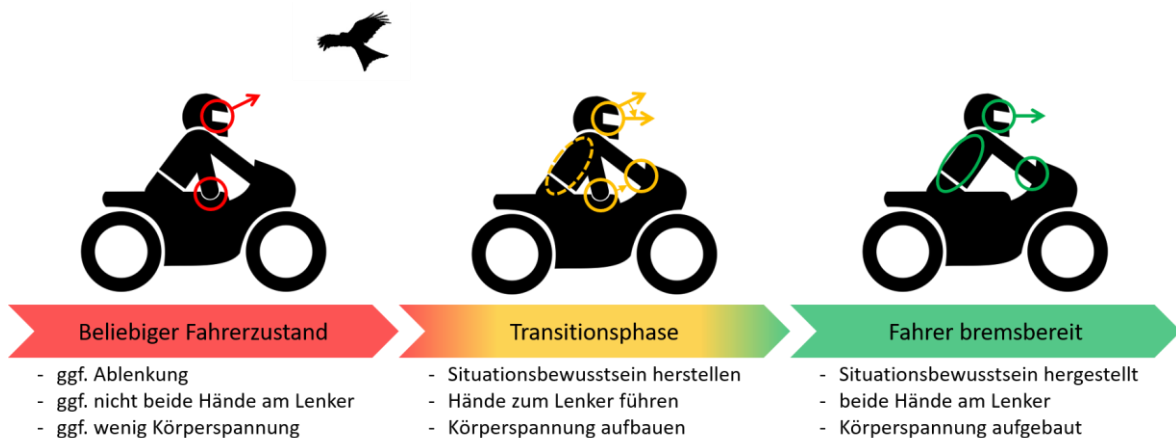
Abbildung 4-1: Phasen des Fahrerzustands vor einem Notbremsmanöver
