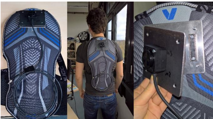
Abbildung 4-16: Rückenprotector mit Beschleunigungssensor
