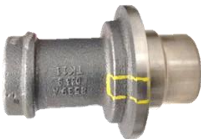
Figura 29. Área de corte para evaluación de dureza en núcleo del diámetro 77.
