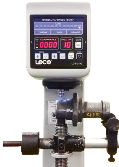
Figura 18. Método para evaluar dureza en el diámetro de 64 mm.
