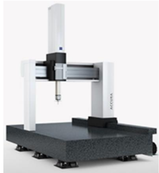
Figura 23. Máquina CMM usada para medir las dimensiones iniciales de los diámetros.
