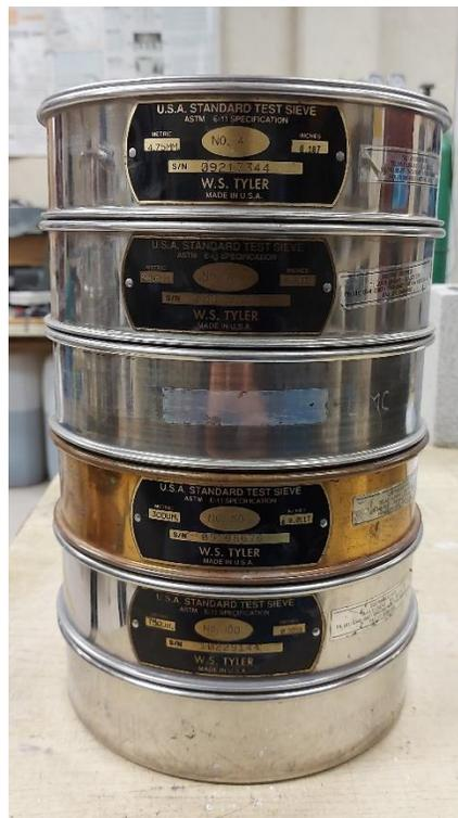
Figura 17.- Tamices para granulometría del agregado fino
