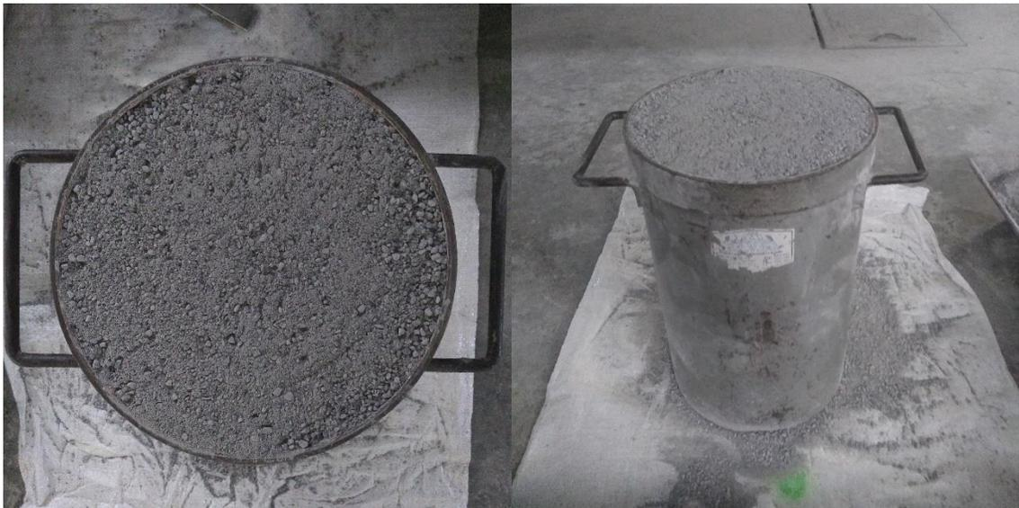
Figura 18.- Determinación de PVSS y PVSC
