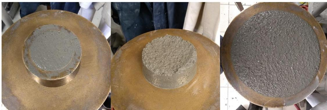
Figura 22.- Prueba de fluidez en matriz de referencia (MC) ASTM 1437
