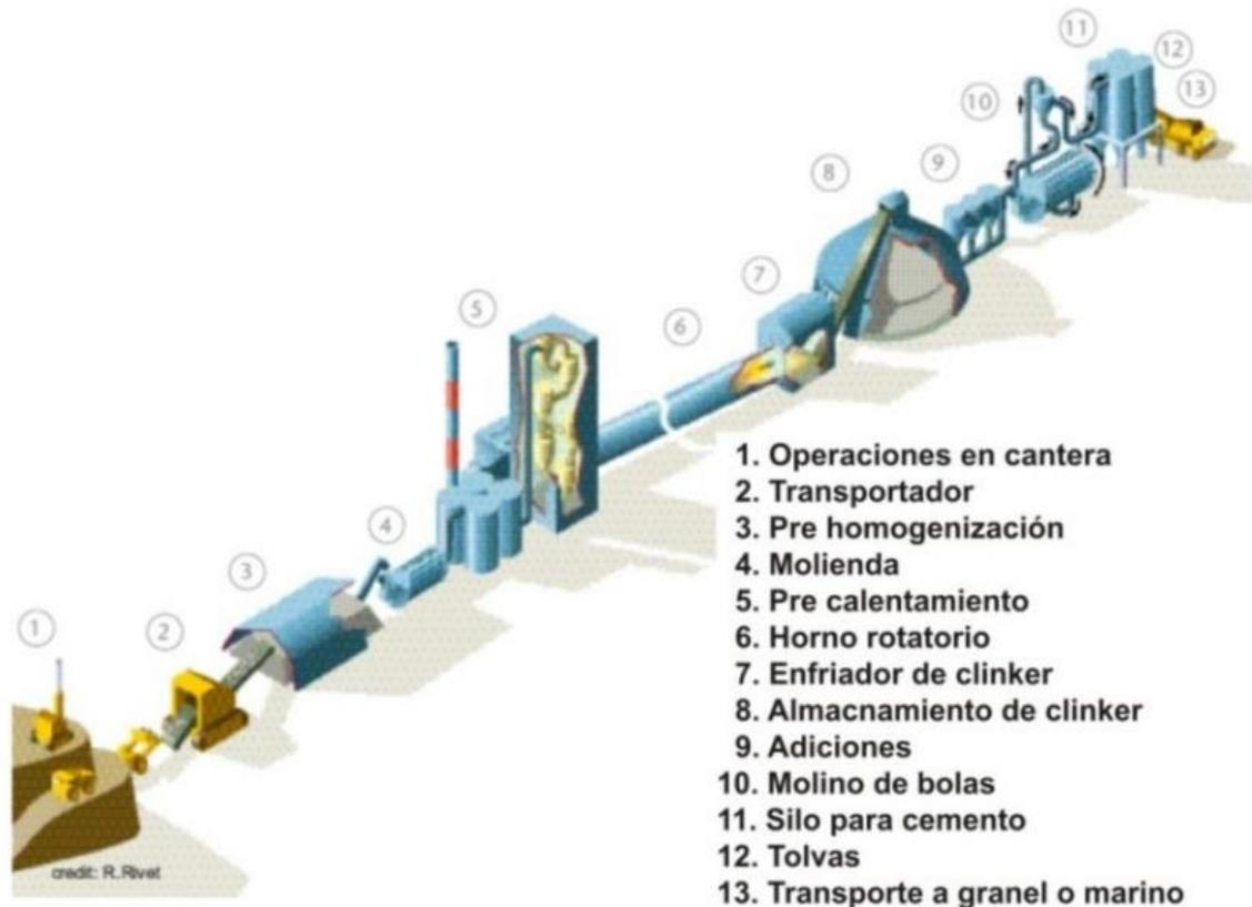
Figura 1.- Representación esquemática del proceso de fabricación del cemento portland
