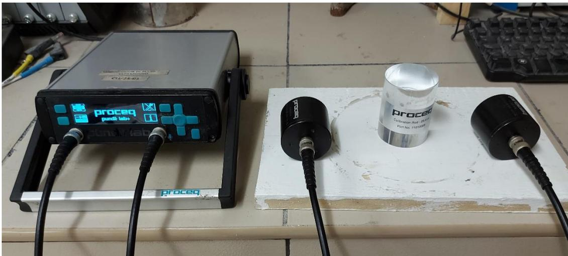
Figura 26.- Medidor de pulso ultrasónico Pundit Lab
