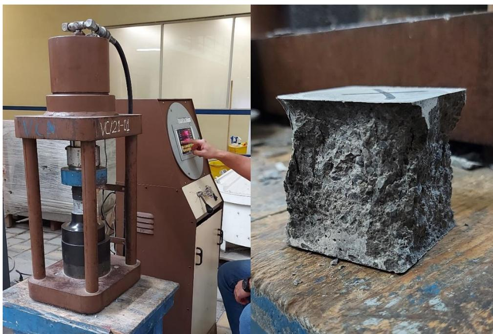
Figura 24.- Prensa hidráulica y cubo post-ensayo
