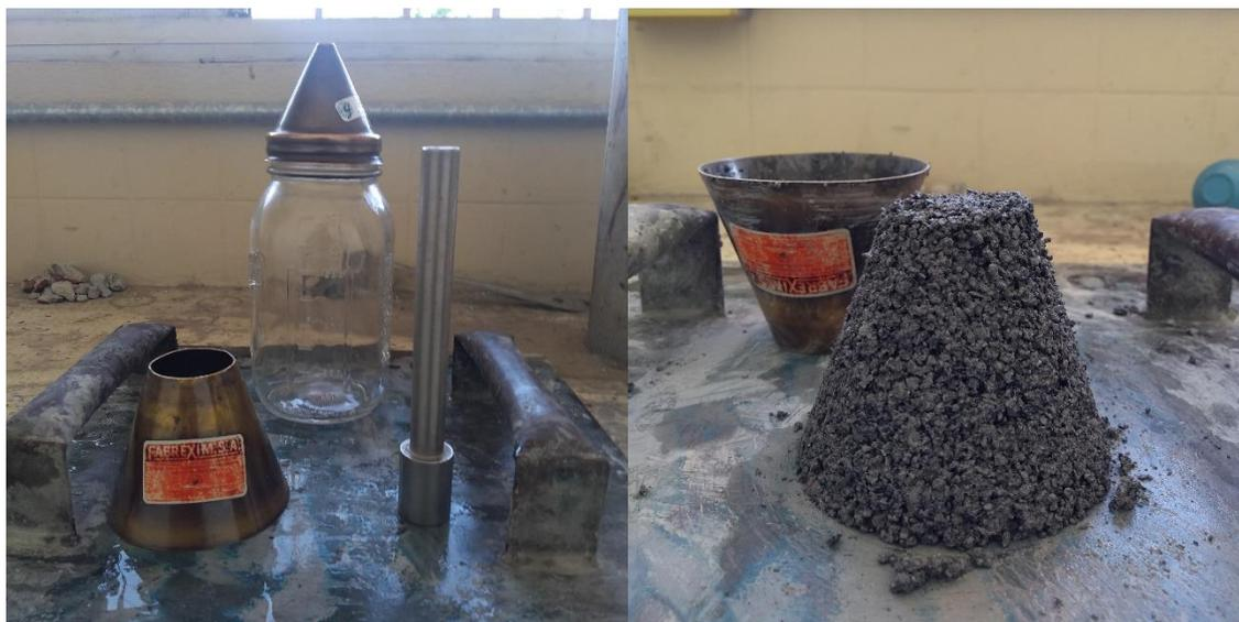
Figura 20.- Equipo para densidad y absorción del agregado fino
