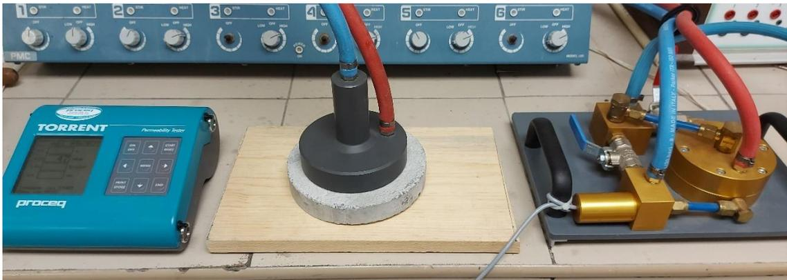
Figura 27.- Permeabilímetro al aire Torrent
