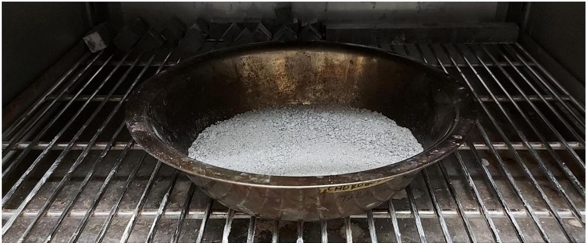
Figura 19.- Determinación del contenido de humedad en el agregado fino
