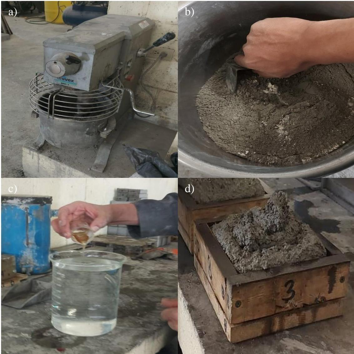
Figura 23.- Proceso de mezclado de los sistemas cementantes
