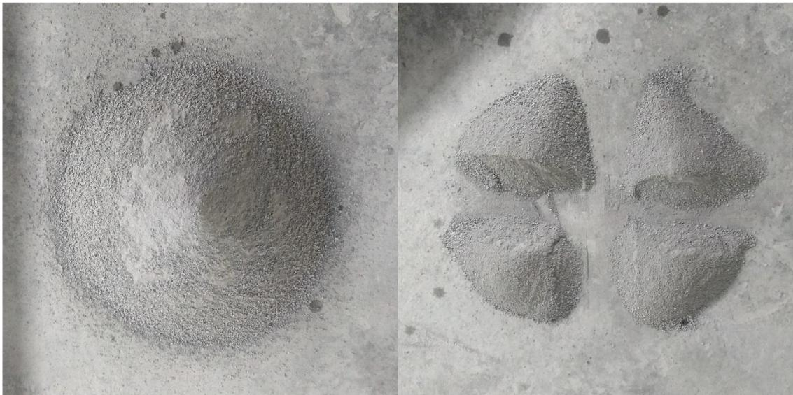
Figura 16.- Cuarteo del agregado fino
