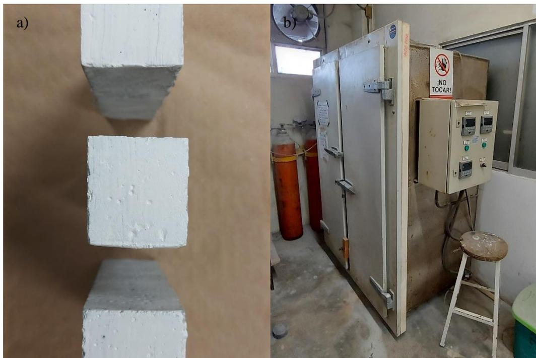
Figura 28.- Recubrimiento epóxico en barras de carbonatación y cámara de exposición
