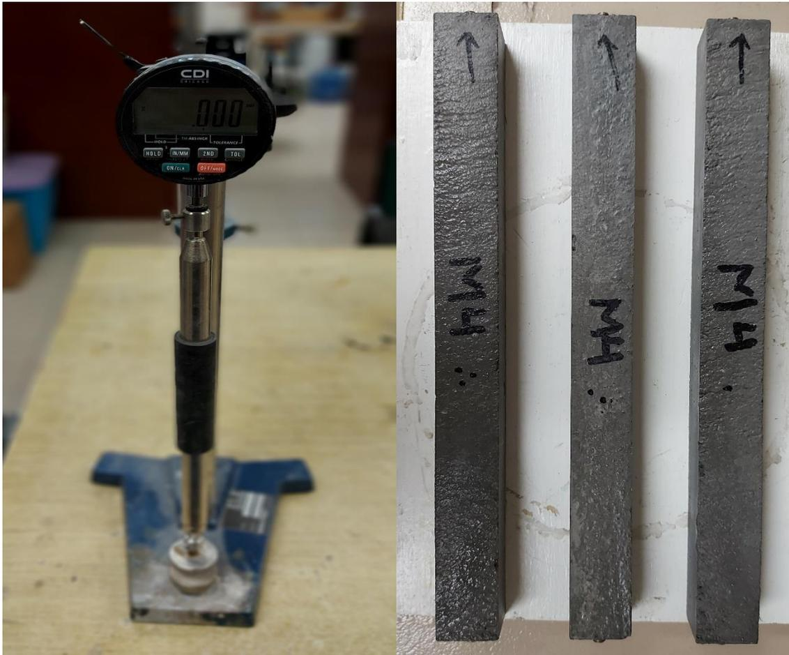
Figura 31.- micrómetro de medición y barras expuestas a sulfatos
