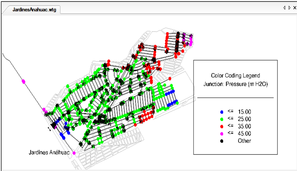
Figura 3-62 Presiones hidráulicas del modelo Jardines de Anáhuac en WaterCAD.
