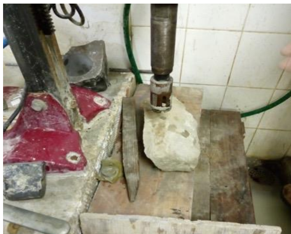
Figura 33. Taladro y broca para obtención de núcleo de la roca.
