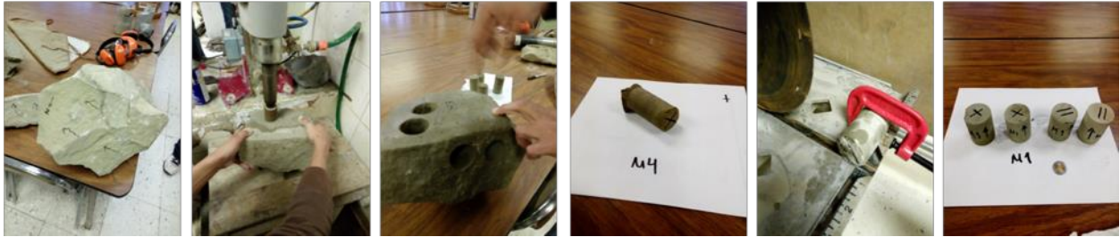
Figura 39. Proceso de elaboración de núcleos a partir de muestras de rocas sedimentarias detríticas (Laboratorio de mecánica de rocas de la Facultad de Ciencias de la Tierra).
