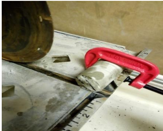
Figura 32. Proceso de medición y corte en la elaboración de núcleos.
