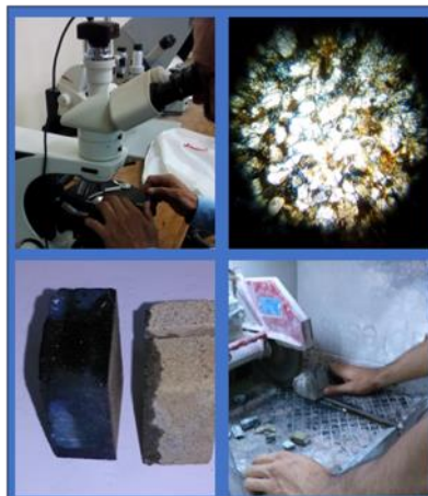
Figura 40. Elaboración de lámina delgada impregnada con pintura epoxy azul (Lob. De Preparación de Muestras Geológicas de la Facultad de Ciencias de la Tierra).
