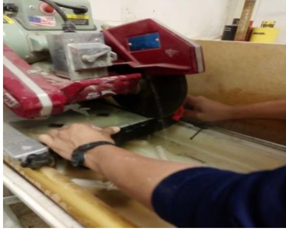
Figura 31. Máquina de corte utilizada para la elaboración de los núcleos.
