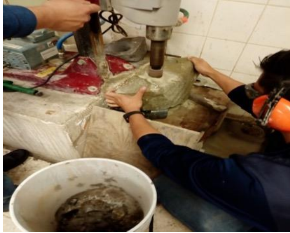
Figura 34. Proceso de taladrado para la obtención del núcleo de la roca (Laboratorio de Mecánica de Rocas de la Facultad de Ciencias de la Tierra).
