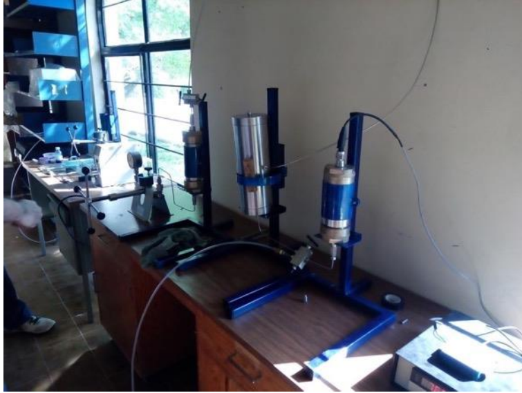
Figura 10. Fotografía del poro-permeámetro de la Facultad de Ciencias de la Tierra, UANL.
