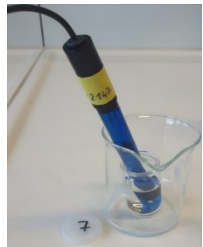
Abb. 1: pH-Elektrode in der Pufferlösung.
