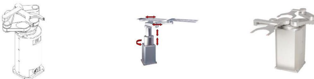
Figura 49 - Robô cilíndrico. Fonte: (International Federation of Robotics, 2021, p. 17)
