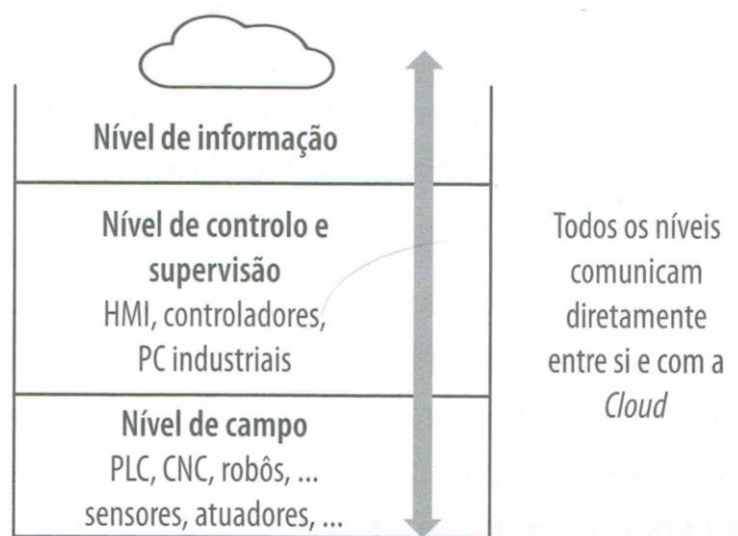
Figura 5 - Estrutura da automação industrial na indústria 4.0. Fonte: (Pinto, 2021, p. 10)
