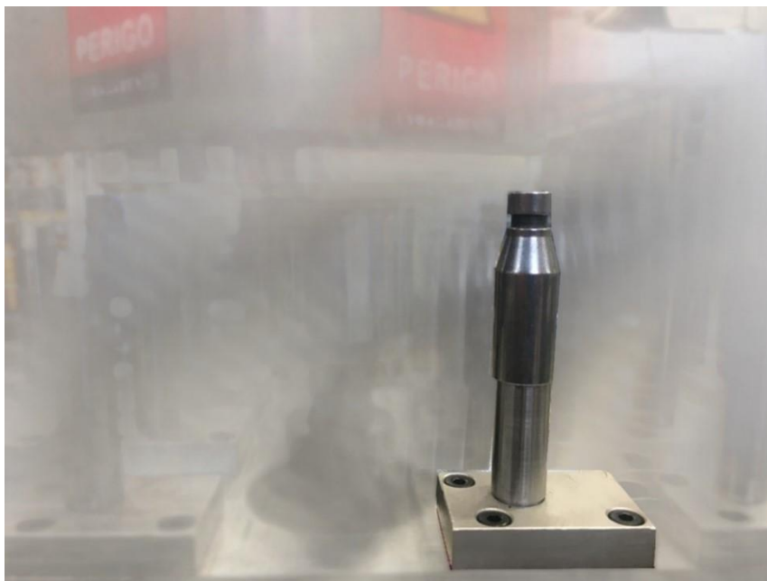
Figura 66 - Exemplo de uma ogiva pousada em um dos pinos da paleta. Fonte: Própria
