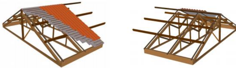
Figura 7: Desenhos esquemáticos de cobertura tradicional, a partir de Moreira (2009, p.13)
