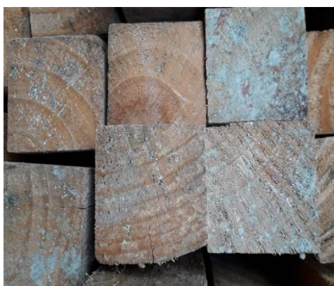
Figura 11: Colônia de fungos formadores de bolor sobre a superfície da madeira. © Rita Doria.
