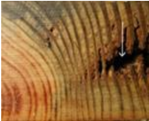
Figura 15: Evidências da ação de fungos ascomicetos na madeira ( Soft rot ), (Henriques, 2011, p. 38)
