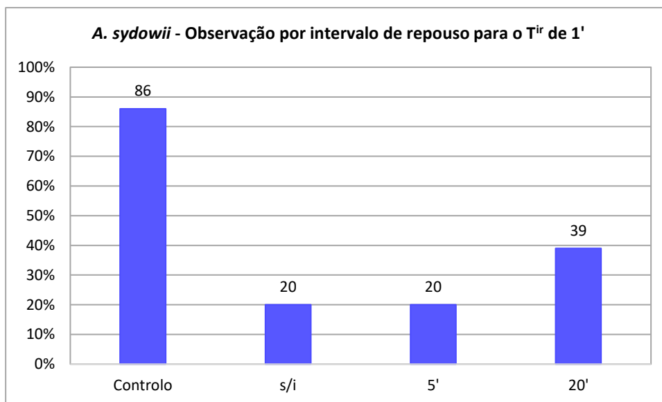
Figura 72: Percentuais médios (n=3) de contaminação, após ensaio de irradiação com UV-C de 1 minuto, para análise do efeito de repetição com intervalos de repouso ( I^{rep} ) 5 e 20 minutos e em relação ao controlo, sem exposição. Amostras de madeira de Maçaranduba ( Manilkara ) infetadas pelo fungo Aspergillus sydowii para Salvador. T^{ir} , tempo de irradiação; s/i, sem intervalo; ', minutos.
