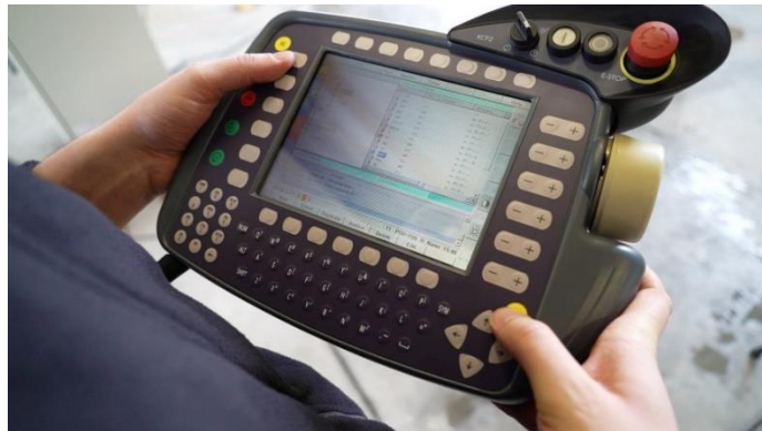
Figure 14 - KCP (KUKA Control Panel), teach pendant device.
