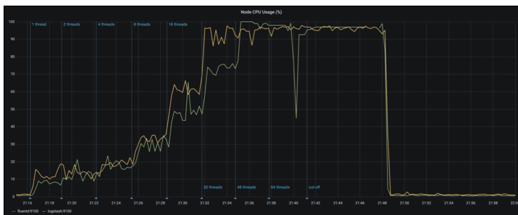
Figura 2.13: Utilização do CPU por um nó do Logstash e do Fluentd
