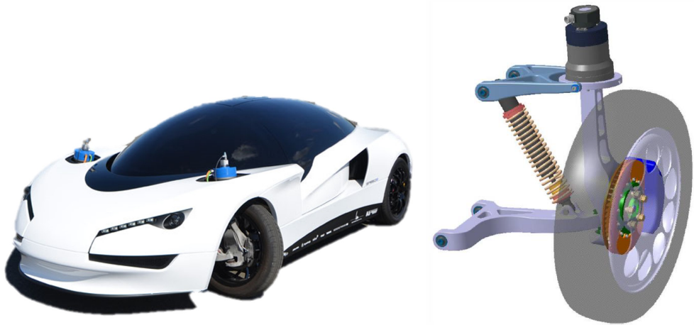
(a) Fahrzeug-Demonstrator SpeedE 2 . Gut zu sehen ist der hohe Platzbedarf des Lenk-Aktors aus der Motorhaube heraus. (b) CAD-Zeichnung des entwickelten Fahrwerks des SpeedE [SKE13]. An der Vorderachse ist kein Traktionsmotor angebracht.
