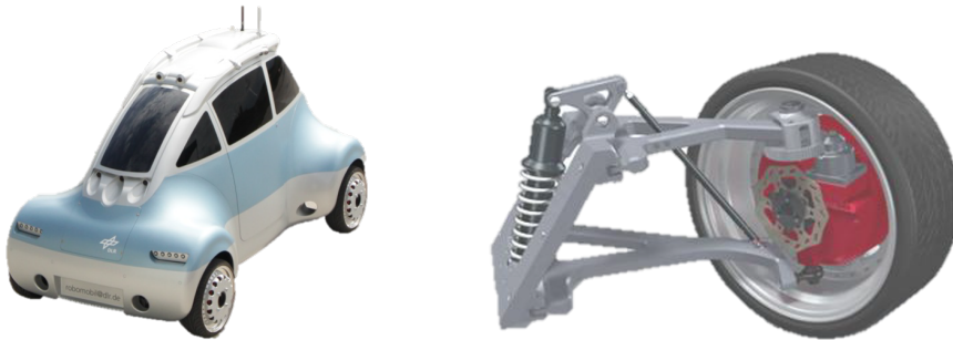
(a) Fahrzeug-Demonstrator ROboMObil mit Karosserie und Platz für einen Insassen [BASS + 11]. (b) CAD-Zeichnung des entwickelten Fahrwerks des ROboMObils [SRB14]. Traktionsmotor und Bremse auf der Radnabe befestigt (rot).
