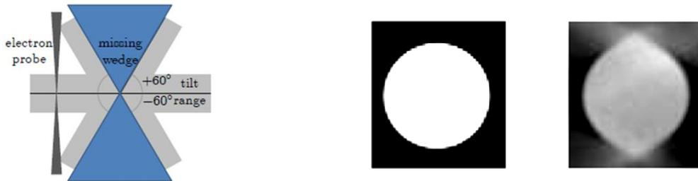
**Abb. 1:** Missing-Wedge-Problematik; links: typische Messwinkel-Restriktionen der Elektronen-Tomographie; rechts: typischer Elongationsartefakt der konventionellen FBP-Rekonstruktion (rechts) eines isotropen Motivs (links)
