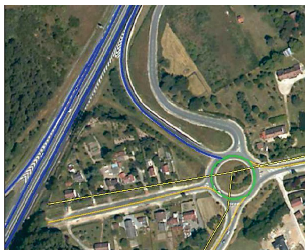
Figure 14. Levé GPS (ligne bleu), BD CARTO (ligne jaune) et BD ORTHO
