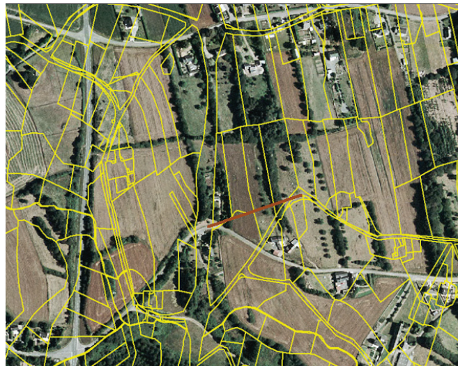
Figure 11. Erreur de géoréférencement sur un cadastre scanné
