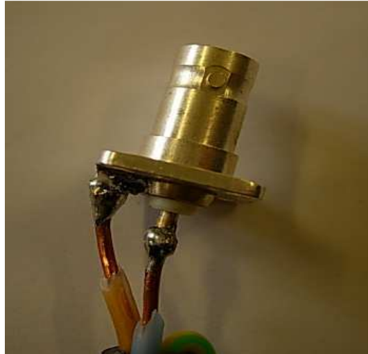
Figure 46. Câble soudé au connecteur BNC
