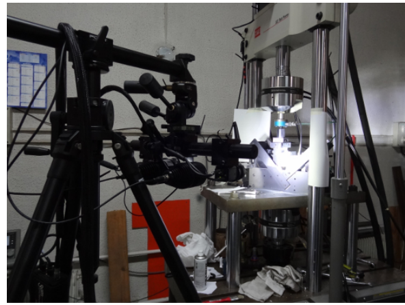
FIGURE 1 – Montage expérimentale de traction/cisaillement sur palier. ① : paliers, ② : capteur d'effort tri-axes, ③ : axe de la machine, ④ : glissière, ⑤ : centre de symétrie, ⑥ : mise en compression par un dispositif chambre/piston réglable par vis
