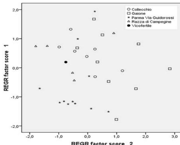
Fig. 4 – PCA degli elementi maggiori e minori. Fattore 1 24,5% – CaO, – Sr, +Al<sub>2</sub>O<sub>3</sub> Fattore 2 15% – SiO<sub>2</sub>, – Zr; +Ba.
