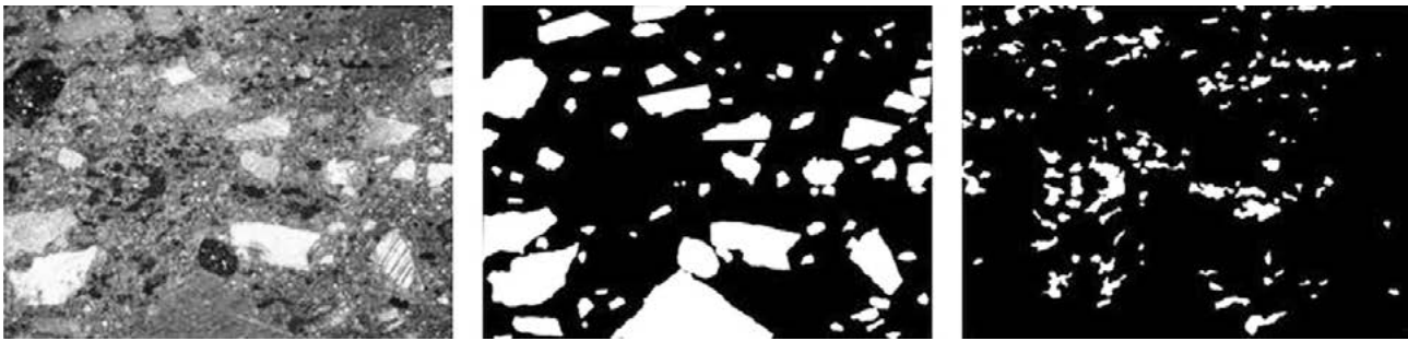
Fig. 6 – Analisi d'immagine (DIP) sul campione GAI 8, foto sezione sottile, maschera dei clasti e maschera dei vuoti.
