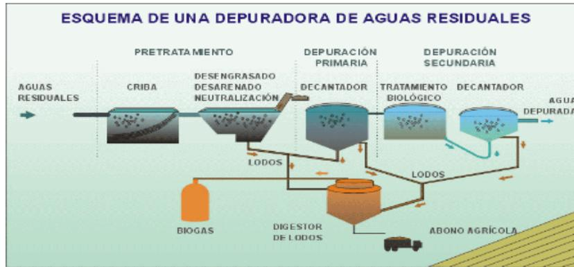
Figura 2 - Esquema de una depuradora de aguas residuales.
