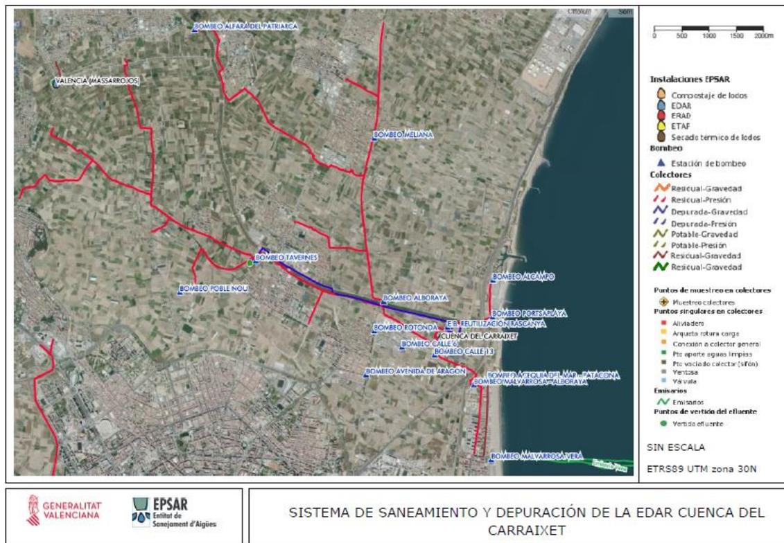
Figura 29 – Estaciones de bombeo para el transporte del agua residual a la EDAR Cuenca del Carraixet. Fuente: (EPSAR, 2021).
