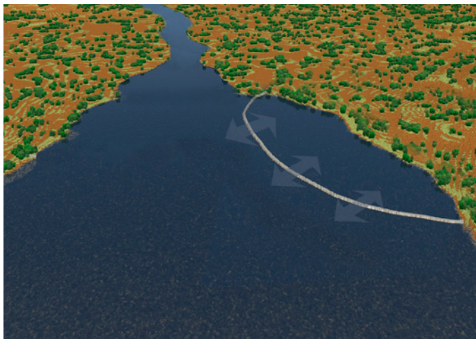
Figura 6.10. Esquema dunha presa de marea delimitada. Imaxe obtida de Aqua-RET ( www.aquaret.com )
