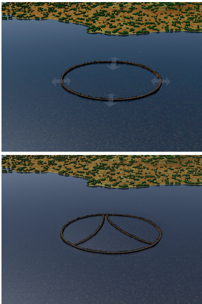
Figura 6.11 (a, b). Esquema de lagoas de marea simple (esquerda) e múltiple (dereita). Imaxes obtidas de Aqua-RET ( www.aquaret.com )
