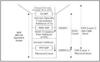
Fig: 2 Protocol layer Architecture
