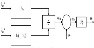
Fig. 4 Rotor Flux Estimator
