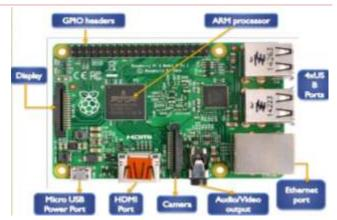
Fig. 2 Raspberry Pi 2b Module
