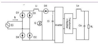
Fig. 4 CSF SMR Converter
