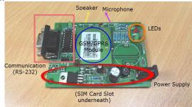
Figure 9. GSM SIM800
