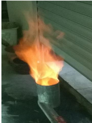
Şekil 4.10. Flare ünitesinde yakılan sentez gaz alevi
