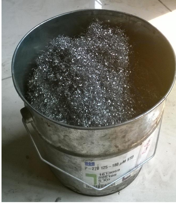
Şekil 3.6. Filtrelerde kullanılan paslanmaz çelik talaşı
