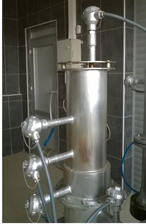
Şekil 3.14. Reaktör üzerinde termokuplların yerleşimi
