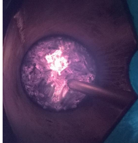
Şekil 3.18. Gazlaştırma deneyinin başlaması (full yükleme) ve bitişi (korun üst kısımdan görünmesi)
